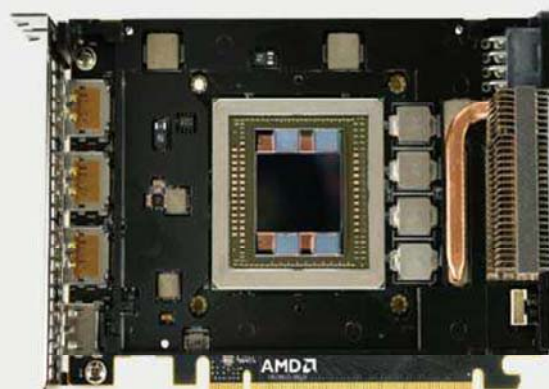
■ R9 Fury nano小小的体积上却设计了两个独立的散热鳍片模块，供电部分带IC控制芯片的MOS管有单独的散热鳍片。
