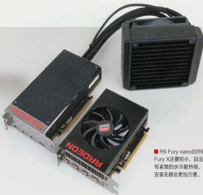
■ R9 Fury nano小小的体积上却设计了两个独立的散热鳍片模块，供电部分带IC控制芯片的MOS管有单独的散热鳍片。
