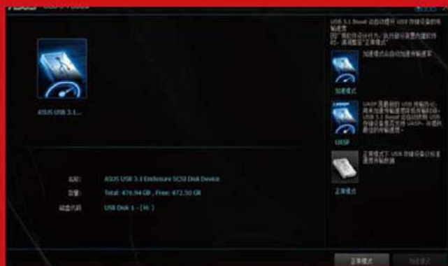
■ 100系芯片组的最大缺陷是没有原生支持USB 3.1技术,为此华硕特别为ROG玩家国度MAXIMUS VII全系列配备了相应的第三方控制芯片与USB 3.1 Boost加速功能。
