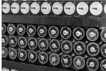
再現艾倫·圖靈（Alan Turing）設計的「炸彈機」（Bombe）；當時設計的目的是要加速二戰期間德國密碼的解密。
