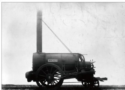
喬治·史蒂文生（George Stephenson）的「火箭號」（Rocket）在1829年的雨丘競賽（Rainhill Trials）中勝出，意義重大，成為風靡全球的火車設計基礎。
