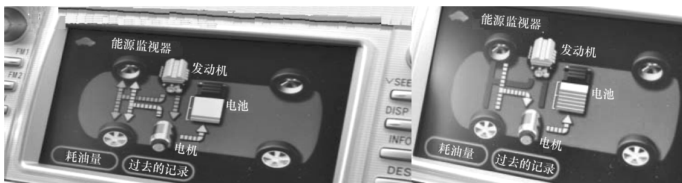
在急加速、高速路或者需要加大转矩的上坡等情况下发动机会及时起动，与电动机同时工作，并且为电池充电
