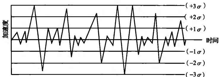
图 9-14 典型随机振动加速度轨迹的时间历程
