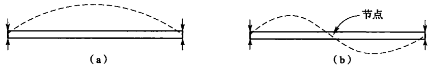
图 1-7 简单支撑梁的一次谐波方式和二次谐波方式
