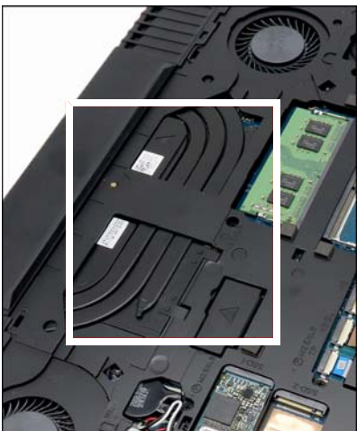
过高的配置,共享式热管,使得 GTX 1060 版 Alienware 13 在极限考机时降频明显
