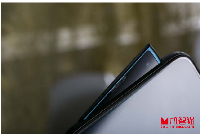
Reno 的侧旋升降结构不仅让前置摄像头升起非常快速且安静，且让它实现了一块完整、无刘海、无开孔的全景屏，观看视线不再受干扰。
