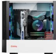
高端显卡竖置可以完全防止PCB弯曲,相对传统机箱省去了购买显卡支架的烦恼
