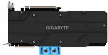
显卡背面也安装了厚实的散热装甲
