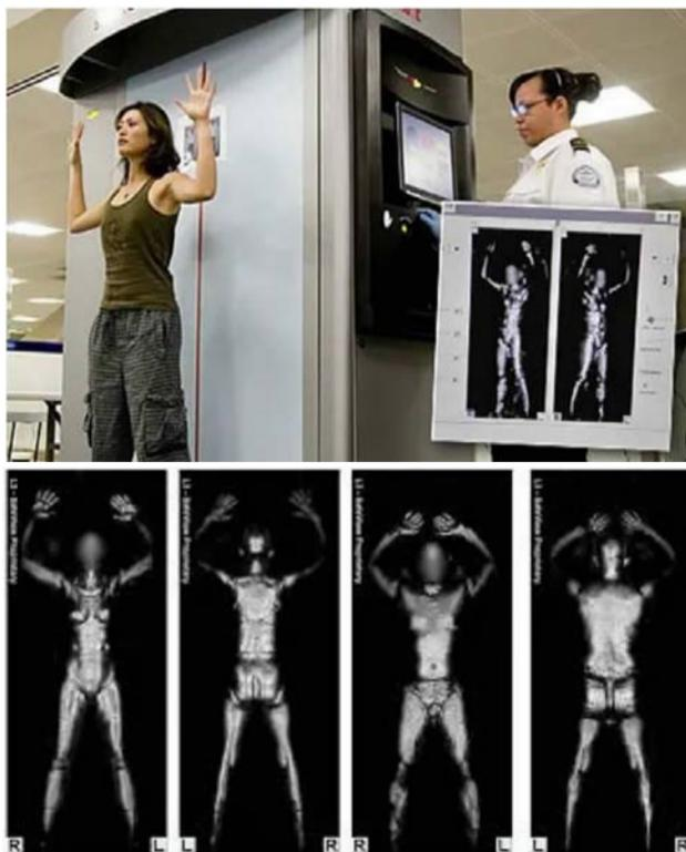
利用微波反射技术的人体扫描安检仪图像 图片来源:tech wire asia
