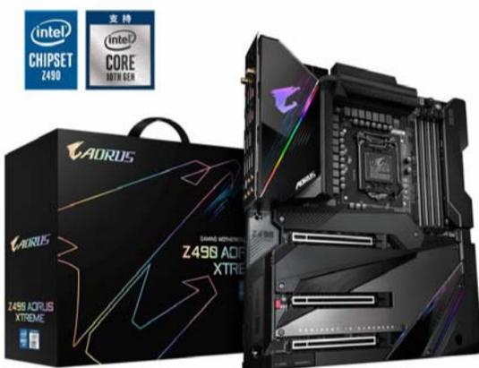
Z490 AORUS XTREME 直接用上了单相承载达 90A 的 16 相数字供电,搭配高品质的钽电容、90A 专用供电晶体管以及第二代堆栈式散热器,保证在高频下系统的可靠性和安全的工作温度。同时主板采用了全新 SMT 内存插槽,通过更为优化的设计,带来更为强悍的内存超频能力:轻松支持 DDR4 5000+ 超高频率内存。
