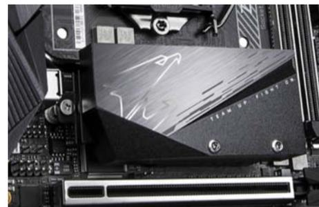
堆叠式M.2散热装甲,让玩家可以同时使用固态硬盘自带散热片与主板装甲
