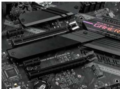
华硕 ROG STRIX B460-F GAMING 搭载了两条 PCIe ×16 插槽,主插槽采用华硕 SafeSlot 高强度安全插槽技术,一体注塑搭配金属骨架,增强了焊点,可为显卡提供优异的支撑和防护能力,应对高端显卡更加从容。
