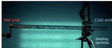
气体在涡流管内部形成了双螺旋
