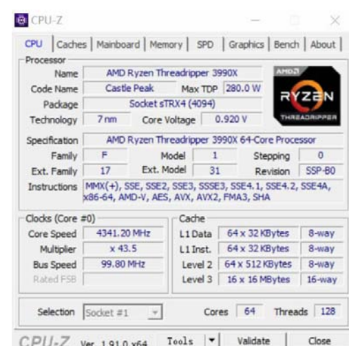
更新到 1.91 版的 CPU-Z 已经可以正确识别出 AMD 锐龙 Threadripper 3990X 的信息
