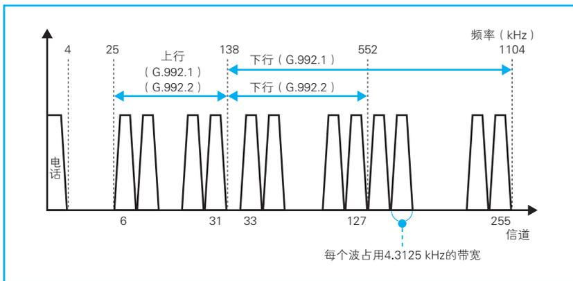
图 4.6 ADSL 使用的波的频率
