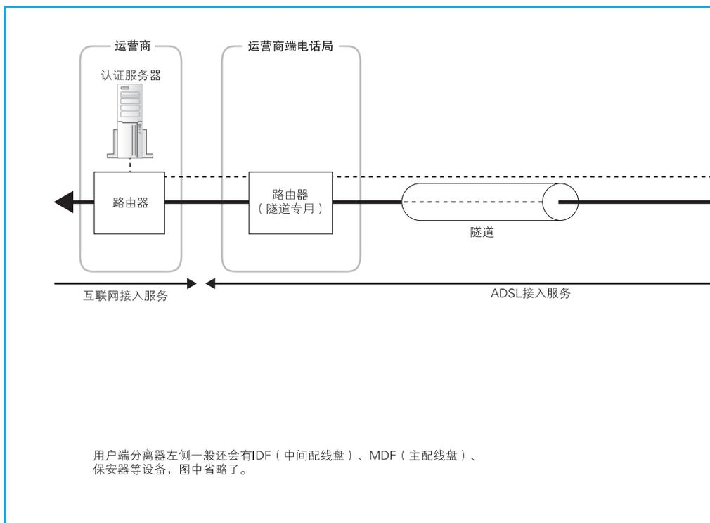
图 4.2 ADSL 接入网的结构 (PPPoE 方式)
