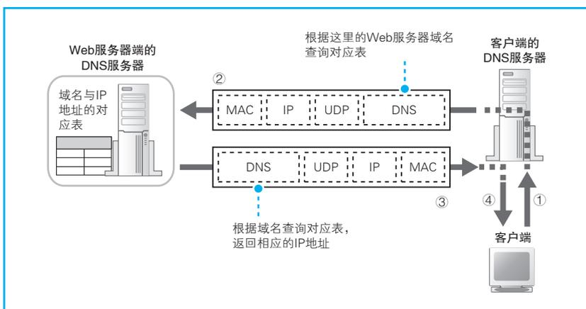
图 5.12 DNS 服务器的一般工作方式
