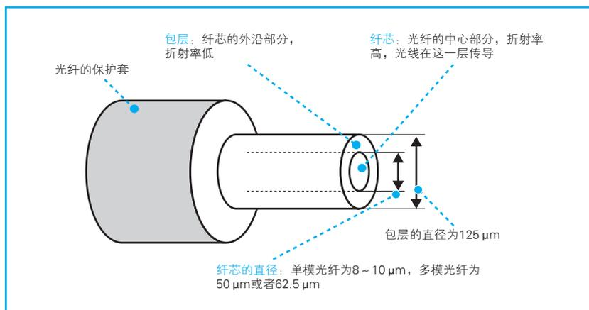
图 4.9 光纤的结构
