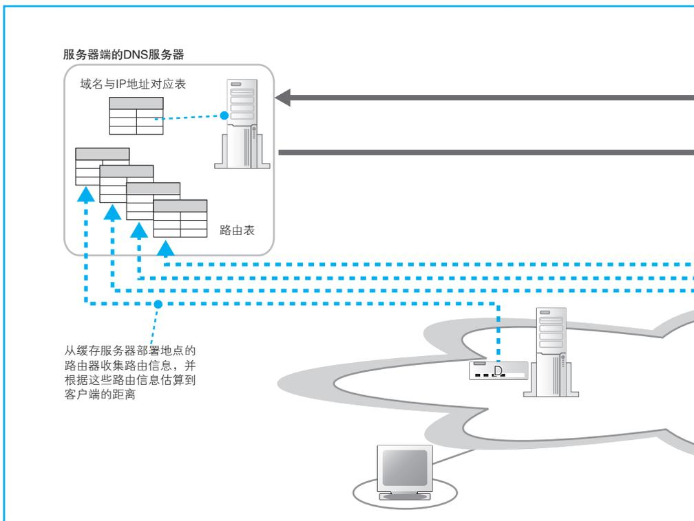
图 5.13 DNS 服务器参照路由信息时的工作方式
