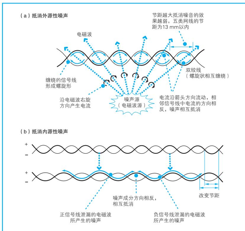
图 3.4 双绞线对噪声的抑制
