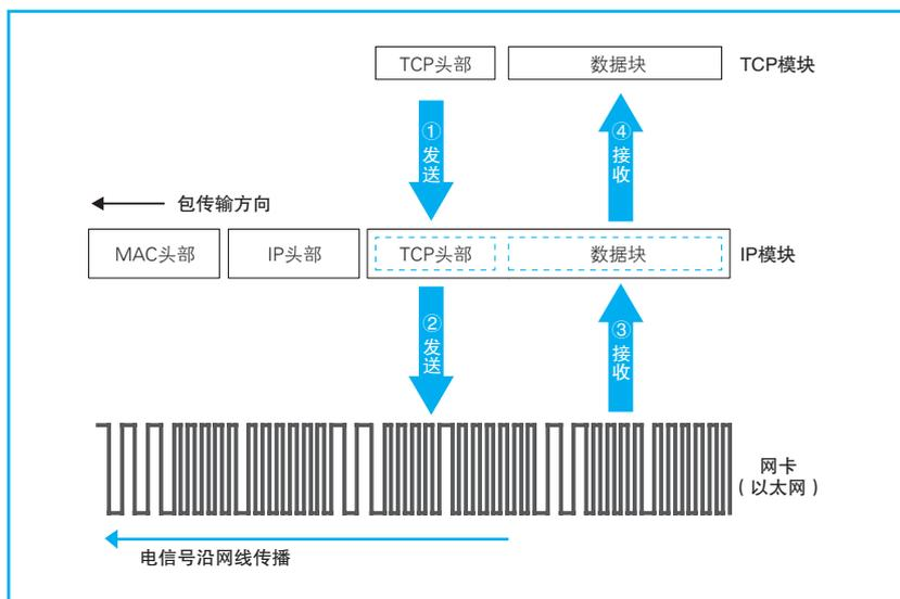
图 2.17 包收发操作的整体过程
