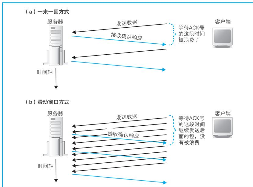
图 2.10 一来一回方式和滑动窗口方式
