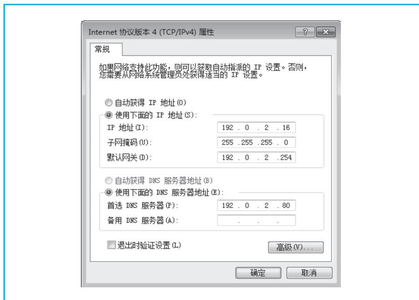
图 1.13 DNS 服务器地址的设置
