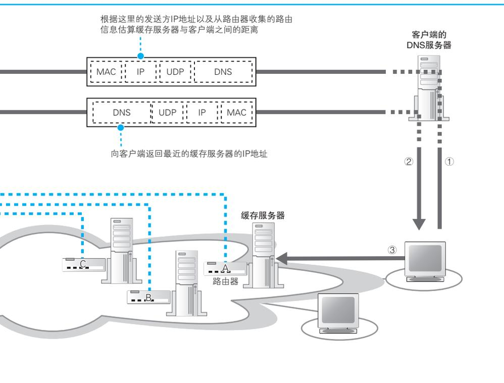
缓存服务器发送测试包并计算往返时间，然后将请求发送到往返时间最短的一台缓存服务器，这样就可以判断出对于客户端最优的缓存服务器，并让客户端去访问该服务器。
