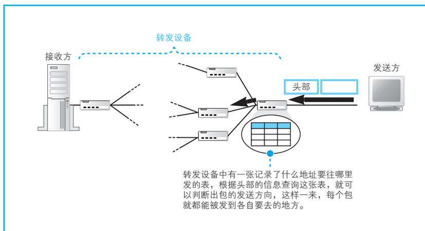
图 2.15 发送方、接收方和转发设备
