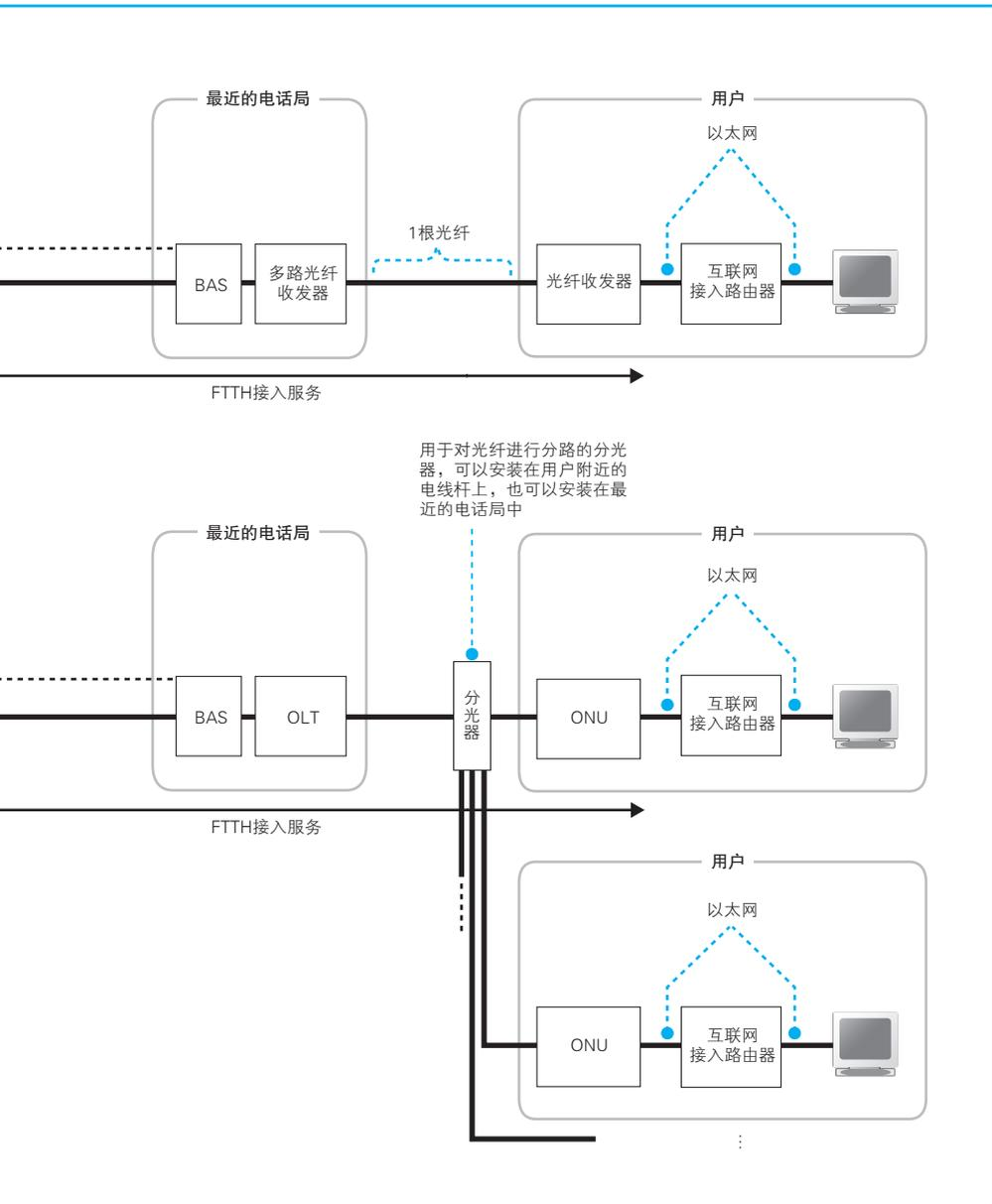
的设备,通过这个设备让光纤分路,同时连接多个用户<sup>①</sup>(图 4.16 (b))。在这种方式下,用户端不使用光纤收发器,而是使用一个叫作 ONU<sup>②</sup>的设备,它将以太网的电信号转换成光信号之后,会到达 BAS 前面的一个叫作 OLT<sup>③</sup>的设备。光信号的传导方式和刚才介绍的直连方式是一样的,但有一点不同,因为多个用户同时收发网络包时信号会在分光器产生碰撞。因此,OLT 和 ONU 中具备通过调整信号收发时机来避免碰撞的功能。具体来说,OLT 会调整信号发送时机并向 ONU 下发指令,ONU 则根据 OLT 的指令来发送数据。反过来,当 BAS 端向用户发送数据时,分光器只需要将信号发给所有用户就可以了,这里并不会发生碰撞,但这样做会导致一个用户收到其他所有用户的信号,造成信息泄露的问题,因此需要在每个包前面加上用于识别 ONU 的信息,当 ONU 收到信号后,会接收发给自己的信号并将其转换成以太网信号。
