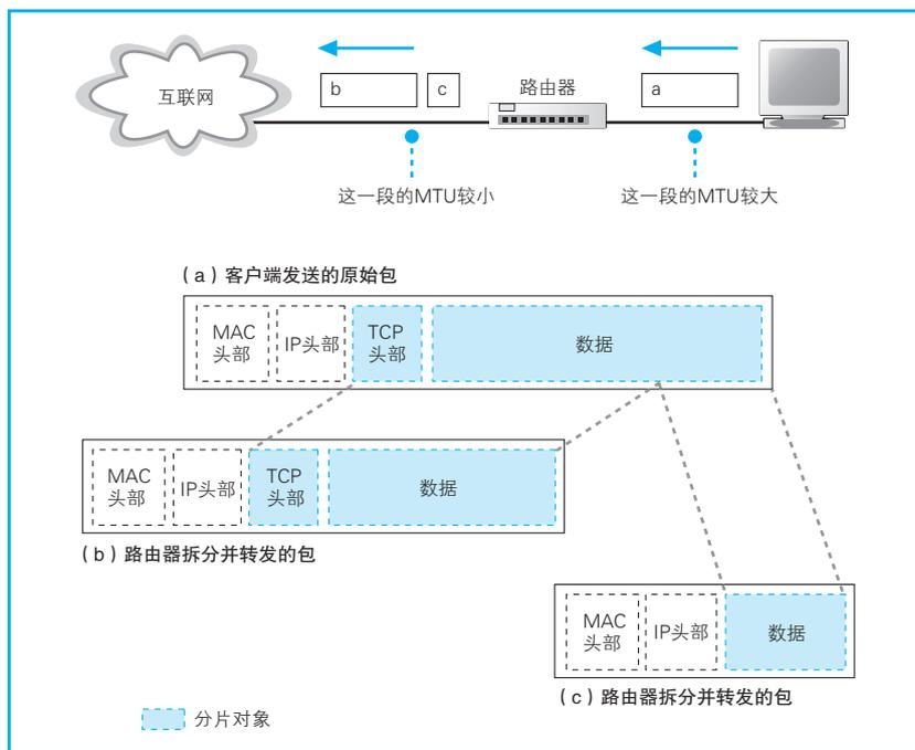
图 3.15 对包进行拆分的分片功能
