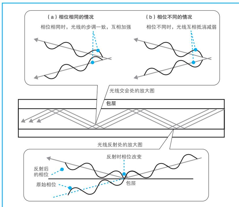
图 4.13 波的反射与相位变化
