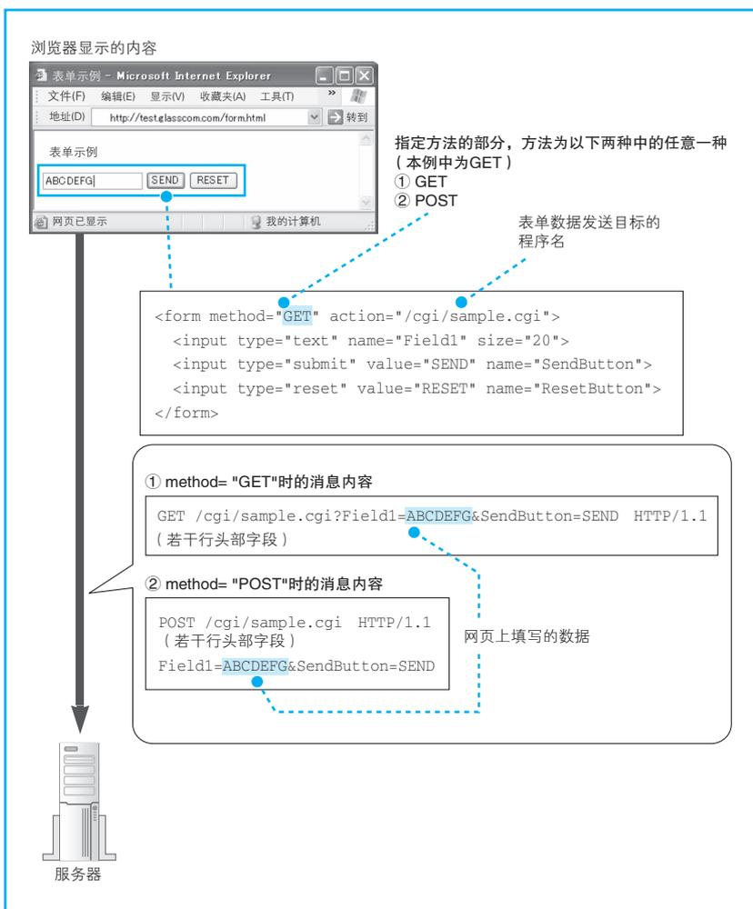
图 6.10 用 HTTP 请求发送表单中输入的内容
