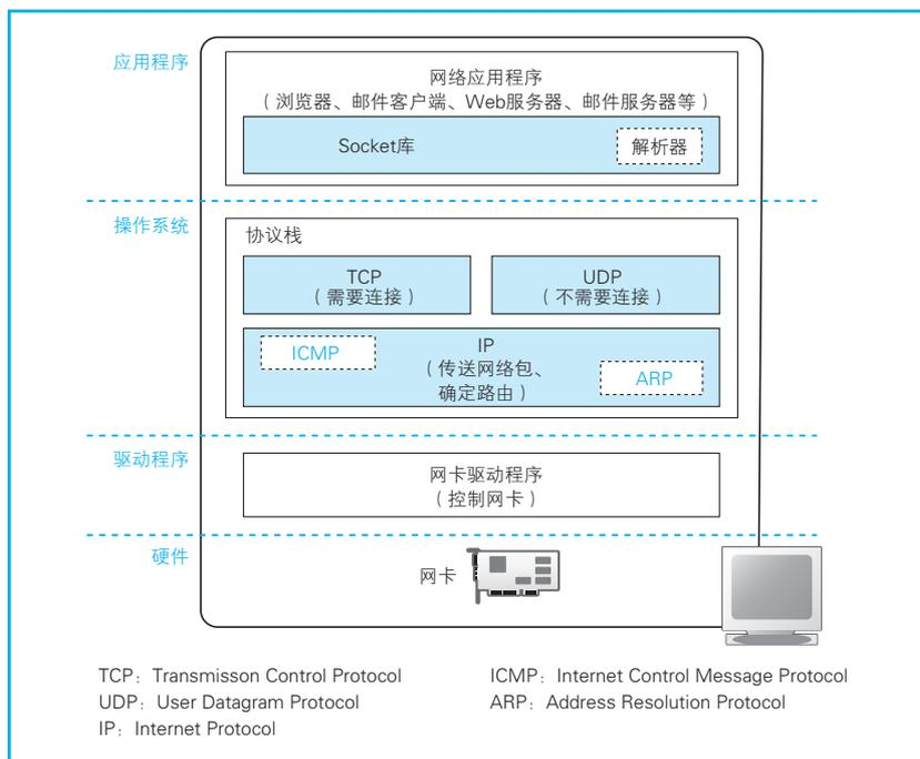
图 2.1 TCP/IP 软件采用分层结构
