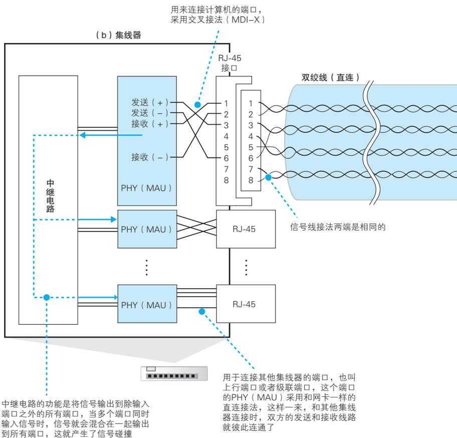
图 3.2 网卡与集线器用双绞线连接的形态
