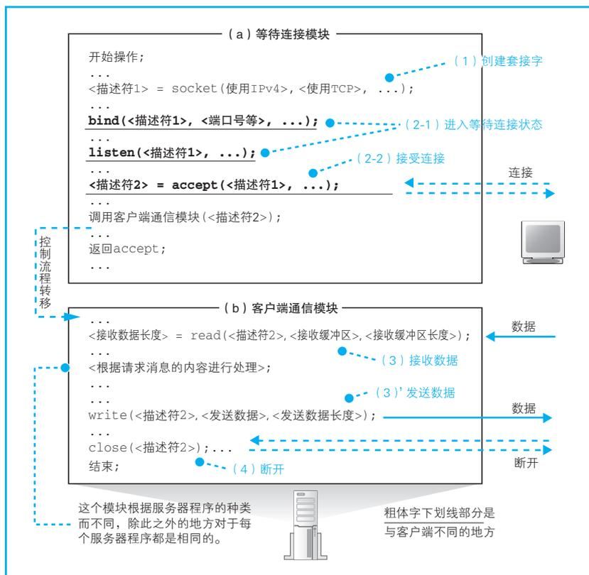
图 6.2 服务器程序的通信操作
