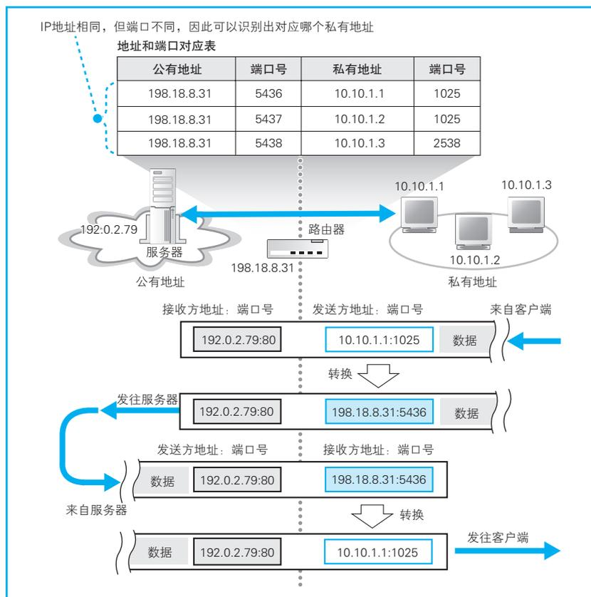
图 3.18 利用端口号改写 IP 地址
