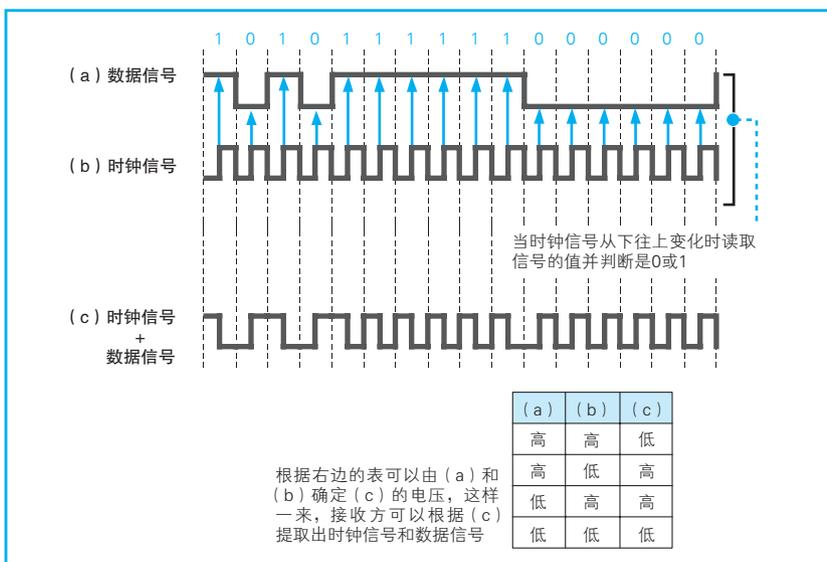
图 2.26 通过时钟测量读取信号的时机
