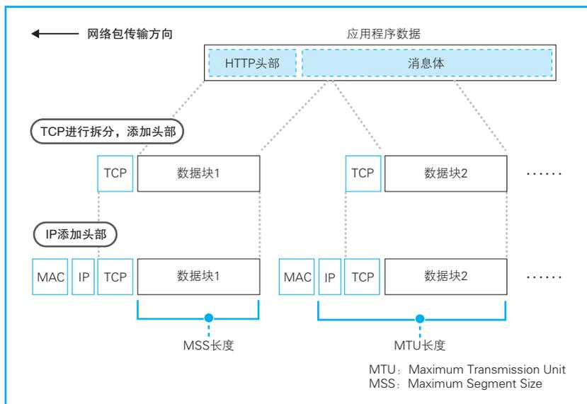
图 2.6 应用程序数据的拆分发送
