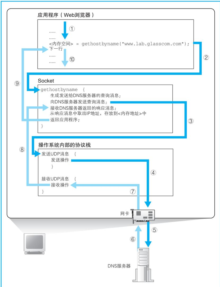
图 1.12 调用解析器时计算机内部的工作流程
