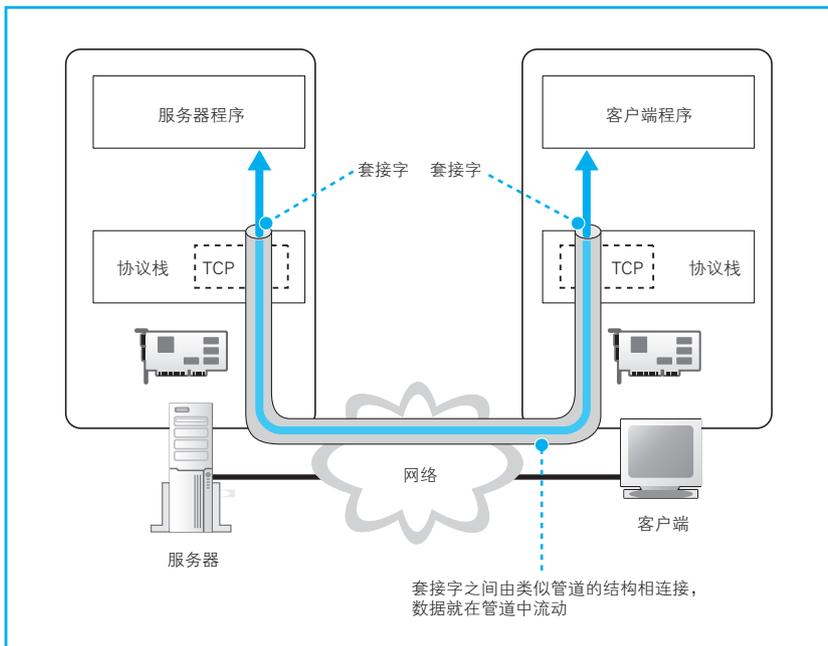
图 1.17 数据通过类似管道的结构来流动
