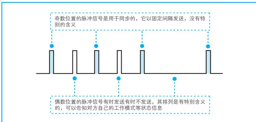
图 3.11 没有传输数据时网络中的信号
