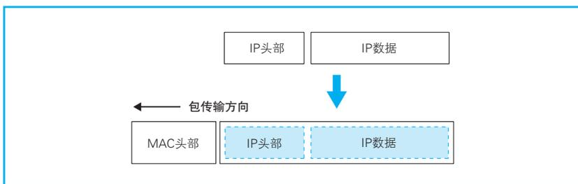
图 3.16 将 IP 包装进以太网包的数据部分
