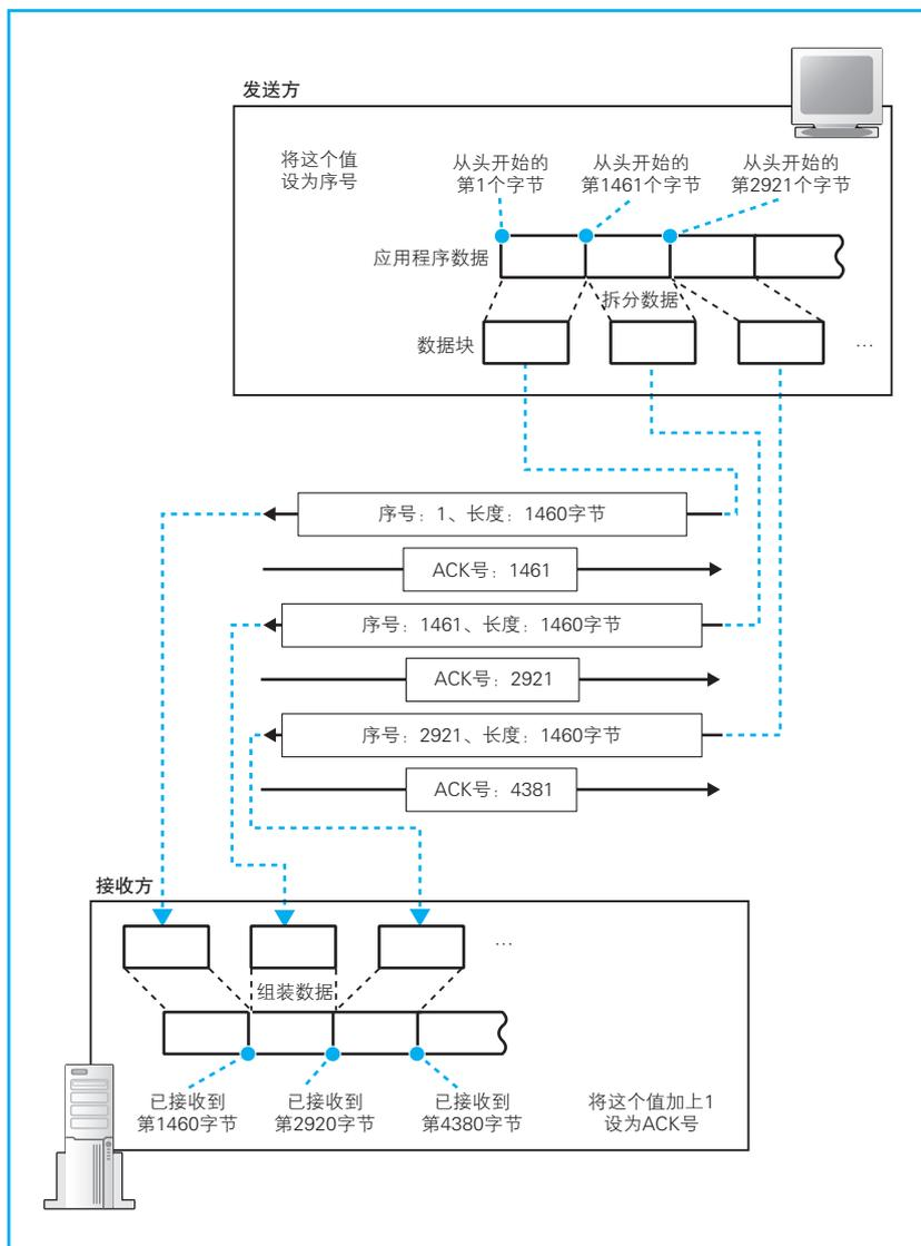
图 2.7 序号和 ACK 号的用法
