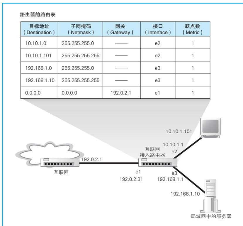
图 3.13 路由器根据路由表对包进行转发
