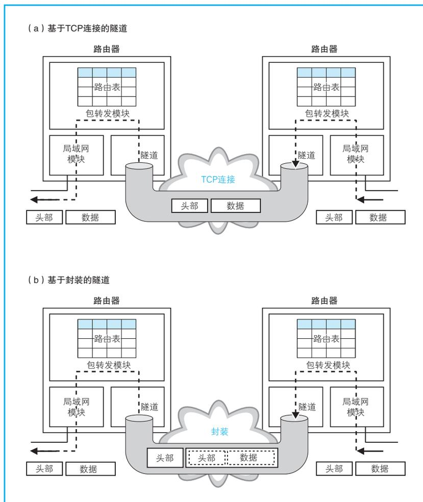
图 4.19 隧道的结构
