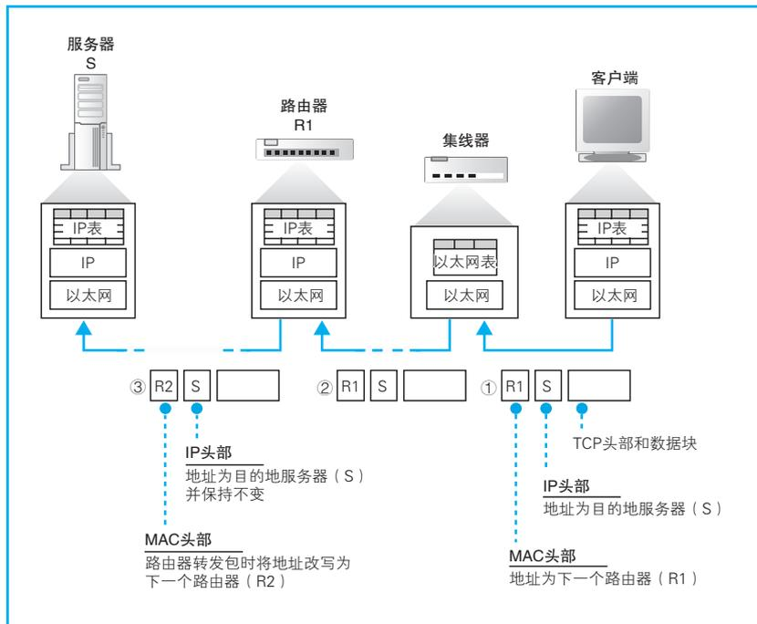
图 2.16 IP 网络包的传输方式
