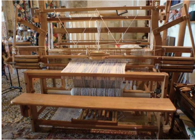
▲一台采取了约翰·凯伊发明的飞梭的织布机，飞梭是一种小小的船型工具，可以带着纬线穿过经线，在很短时间内大大提高了织布效率。
