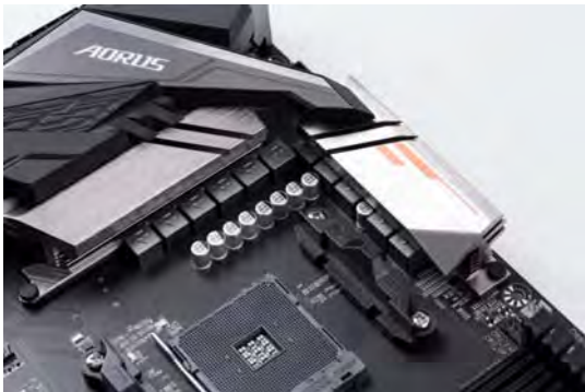
配备混合式数字供电,并加装了大型 VRM 散热装甲
