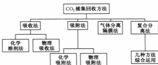
图1 目前主要的 \text{CO}_2 捕集方法
