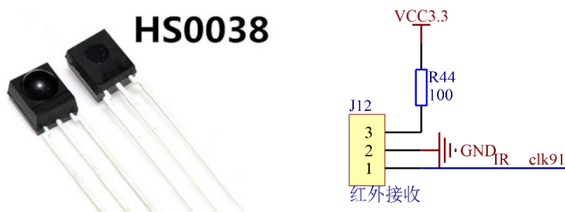
图 5-26 红外接收电路和实物图
