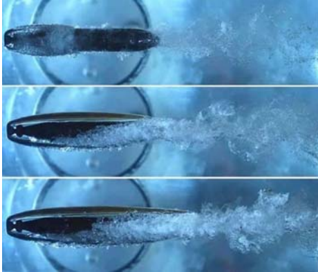
超空泡技术利用空穴产生气泡@UNIVERSITY OF MINNESOTA
