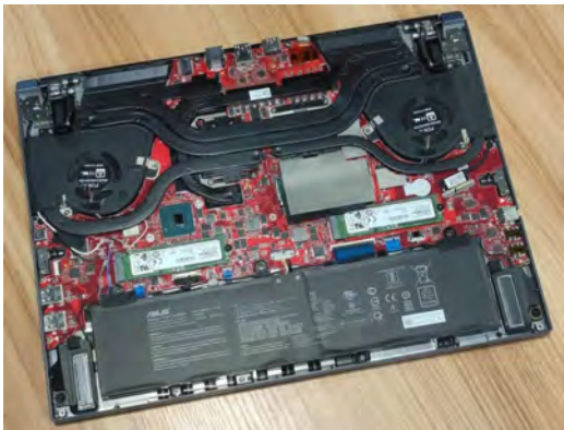
双风扇五热管四出风口散热规格,内部设计完整
