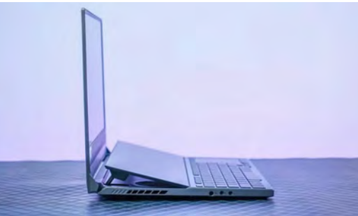
机身厚度在高性能本里算是比较薄的,左侧是电源口和3.5mm音频,右侧是USB大口和雷电3
