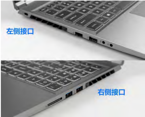
▲机身左侧有网线口、USB2.0口和音频口,右侧是2×USB3.0口和SD读卡器口,相当丰富实用
