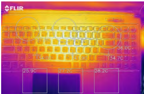
▲Z3 Air的C面相对高温区在键盘区的中部,双考机1小时后,最高也就42℃(室温22℃)。游戏操控WASD按键区域仅35℃,凉爽。而右侧的上下左右光标区域只有28℃,小键盘区30℃左右。腕托区也是凉爽的,不超30℃。该机噪声也不算大,键盘面54.6dBA,完全谈不上吵闹
