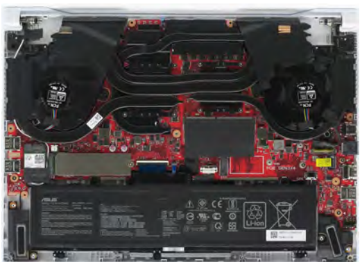
▲这是天选Air的内部。双风扇五热管,四个出风口。注意DDR4 3200内存是以“板载8GB+插槽8GB”的形式存在的,要扩容只能替换掉插槽的8GB。另外,它有一根空余的PCIe Gen3×4插槽可供扩容SSD
